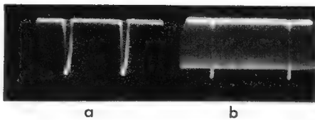
Bild 8. Oszillogramm der Synchronisierungssignale an der Anode der EH 90 in Bild 7. a) Zeile, b) Bild, jeweils 75 V ss
